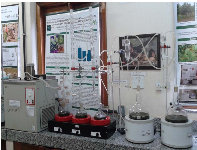
Figura 2. Processo de extração do óleo essencial e hidrolato de L. alba com a utilização do aparelho de Clevenger. Fonte: Maia, J.L.S. (2014).
