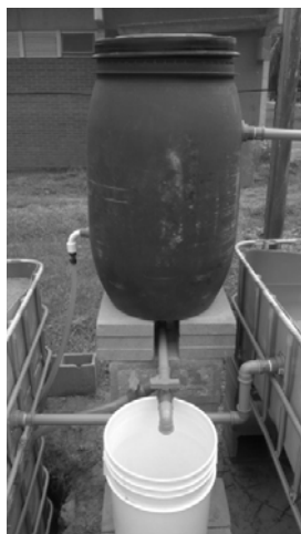
Figura 2. Filtro de sólidos por decantação utilizando um tambor plástico de 150 L.
